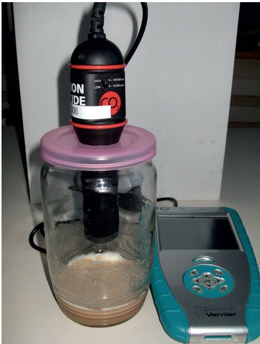
Jednoduchá aparatura na sledování tvorby CO 2 při množení kvasnic
