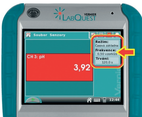
Obr. 3 – nastavení měření na LabQuestu
