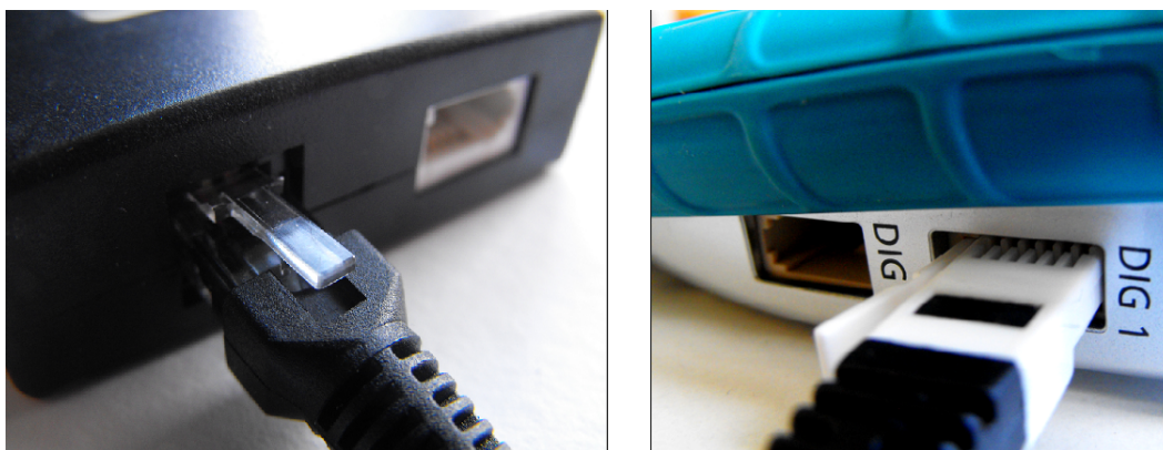
Obrázek 1: Vlevo připojení příslušného kabelu k optické závoře, vpravo k rozhraní LabQuest
