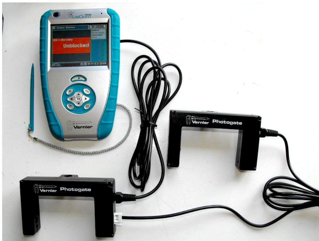
Obrázek 4: Řetězové zapojení dvou optických závor
