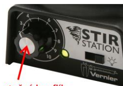
otočný knoflík magnetické míchačky
